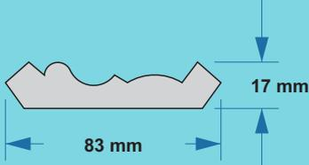
**S**ancas em EPS (Isopor) de alta densidade que proporcionam maior resistência mecânica, dureza superficial e melhor acabamento.
